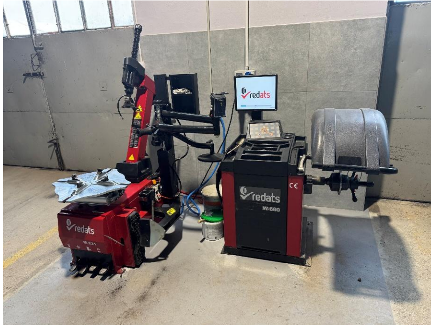
Stanowisko do wymiany i wyważania opon w samochodach dostawczych i osobowych o masie całkowitej do 3,5 tony
